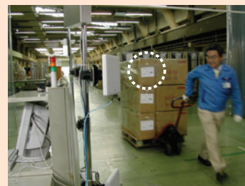
ゲートを通過しながらパレットに搭載した段ボールのタグを一括して読み書き。検品の精度、作業効率が大幅に向上。○囲み内がタグ付きのシール
