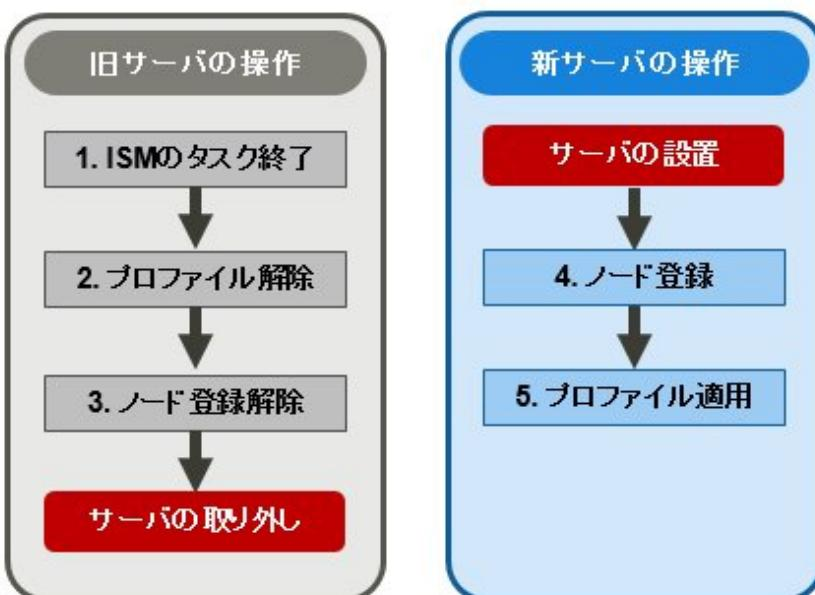
図2.13 仮想IO管理機能を使用したPCIカードの交換
