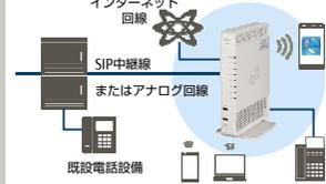
既設電話交換機の配下にMobiSartを接続することで、スマートフォンの内線利用、SIP固定電話機の利用が可能です。さらに、現在利用しているインターネット回線をそのまま利用し、モバイルPC、タブレット、スマートフォンのデータ通信を無線LAN環境でご利用できます。
