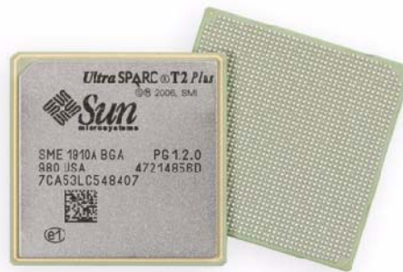
図 3. マルチスレッドテクノロジーを搭載するUltraSPARC T2 Plus プロセッサ
