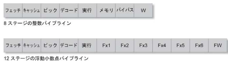
図 8. UltraSPARC T2 のコアごとの整数パイプラインと浮動小数点パイプライン
