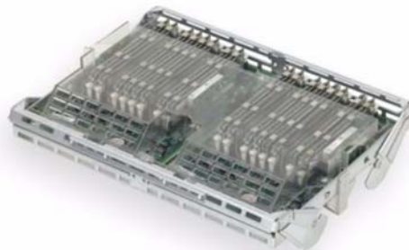
図 11. オプションのメモリ・メザニン・アセンブリキットを使用することで、Sun SPARC Enterprise T5240は、最大128GBのメモリ容量をサポート。
