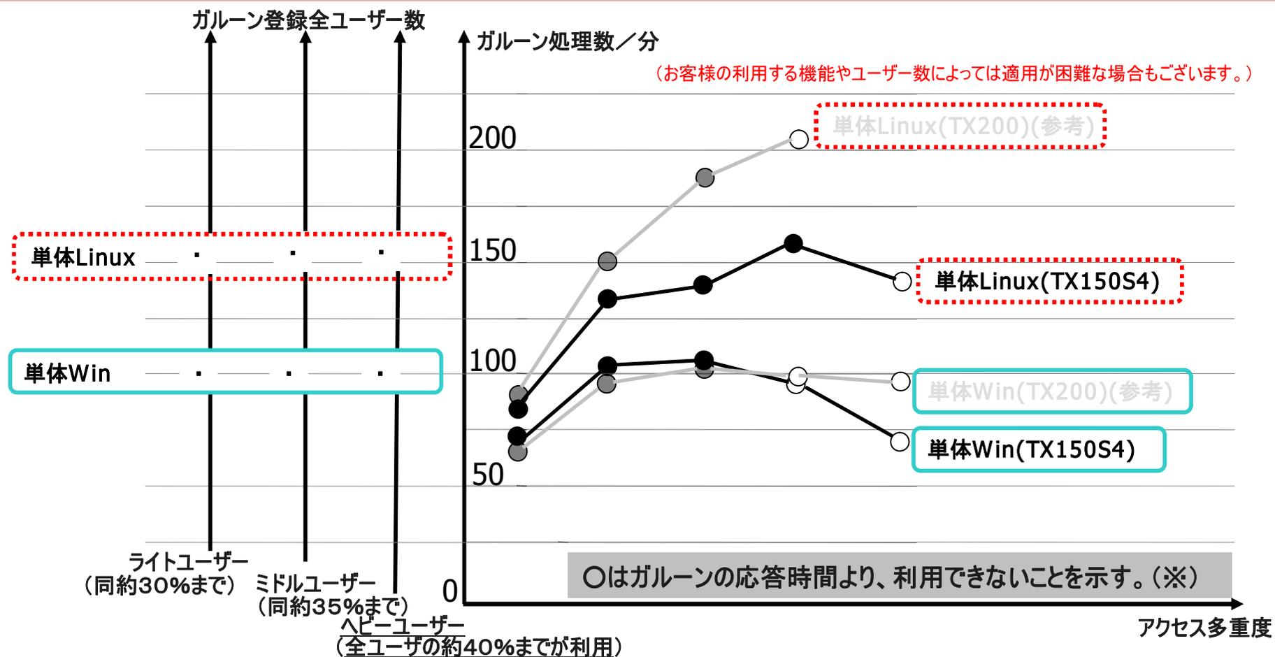
※アクセス多重度を段階的に増加させたときのガルーン処理数とガルーンの応答時間の変化を測定。
