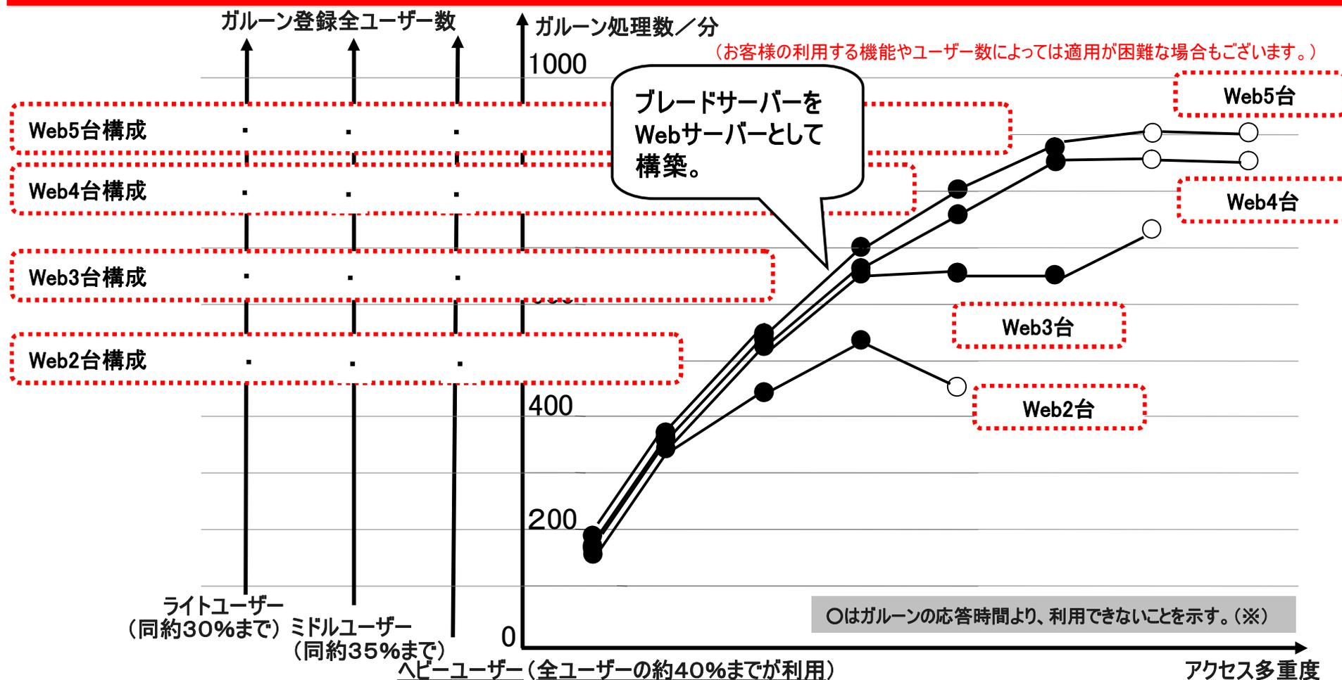
※アクセス多重度を段階的に増加させたときのガルーン処理数とガルーンの応答時間の変化を測定。
