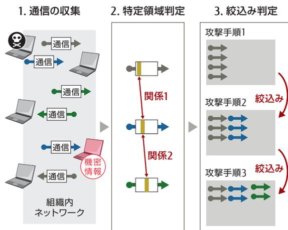
開発技術を、2,000台規模の端末が接続された大量の業務通信が流れているギガビットのネットワーク環境で、RATの潜伏活動を再現しながら実証評価し、全通信パケット量の0.0001%に当たるRATの攻撃通信をすべて検知すると共に、業務通信を攻撃通信と誤検知しないことを確認しています。
