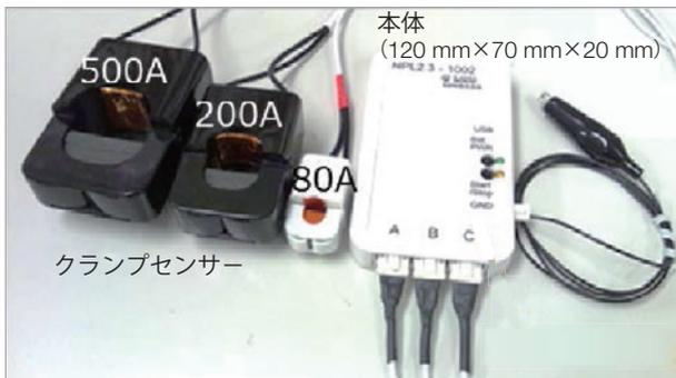
図-2 非接触型電力データロガー NPL
