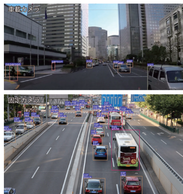
図-3 車載カメラ(上段)、固定カメラ(下段)で取得した映像の車両・人物分類
