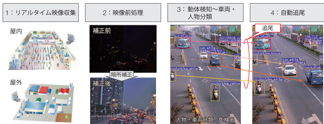
図-2 Deep Learning方式による車両・人物分類処理フロー
