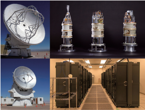
図-2 アルマ望遠鏡への日本の貢献 (左上)12 mアンテナ, (左下)7 mアンテナ, (右上)3種の受信機, (右下)ACA相関器
