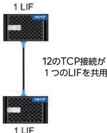
ソースノード、デスティネーションノードまたは両方のノードに 2 つのクラスタ間 LIF が構成されている場合、ONTAP はデータ送信用に 12 の TCP 接続を確立します。ただし、図 2.7 に示すように、両方の接続で同じ LIF を使用するのではなく、一方の接続では一方の LIF ペアを使用し、もう一方の接続ではもう一方の LIF ペアを使用します。この例は、12 のクラスタ間 TCP 接続を生成するクラスタ間 LIFs の異なる組み合わせを示します。
