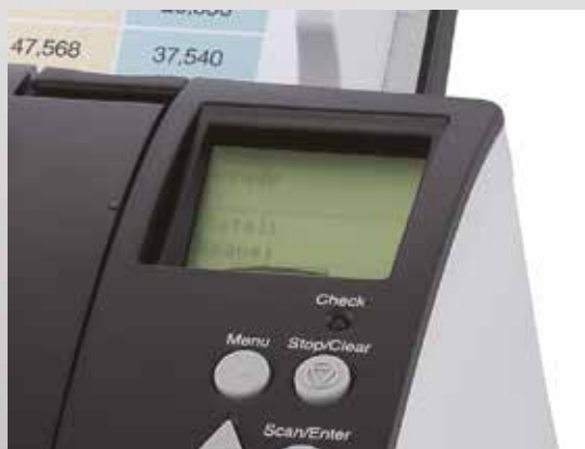
Pannello di comando con display a cristalli liquidi integrato
