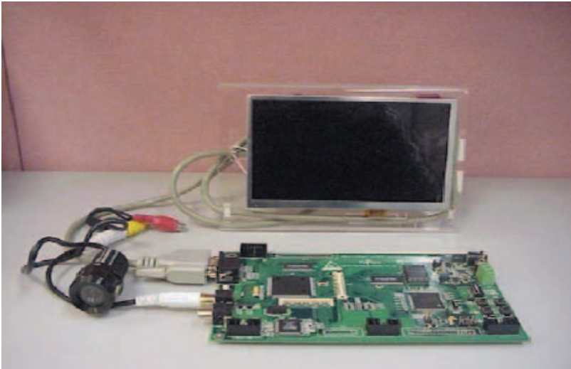
Mint SDK – 带液晶及后视摄像头的汽车应用完整解决方案
