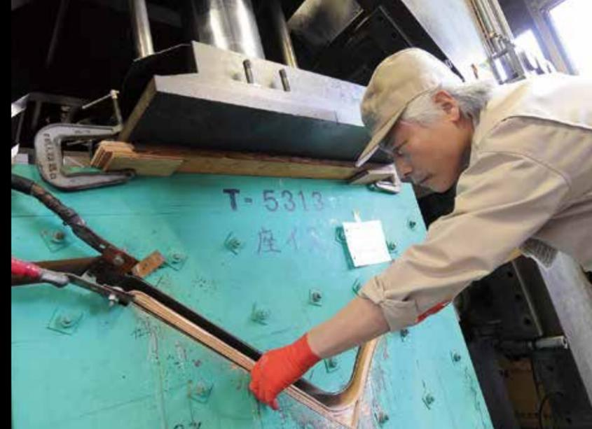
将薄板重叠在放入模具，通过冲压机加压、加热进行造型和粘接。木材质地、形状是不一致的，通过温度和压力的微小调节进行均质加工则是木工匠的绝技。粘合剂的配方也需根据加工当天的气温和湿度来调整。
