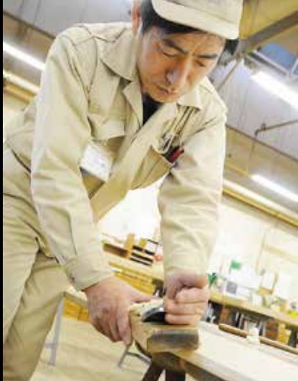
定制大会议桌的削刨工序。虽然有些厂家注重效率而采用磨砂机，但天童木工始终如一地采用刨光加工处理，因为这是木工匠的精髓。
