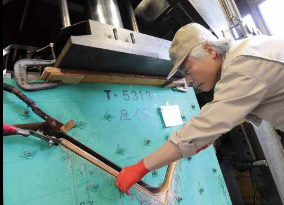
将薄板重叠在放入模具，通过冲压机加压、加热 进行造型和粘接。木材质地、形状是不一致的， 通过温度和压力的微小调节进行均质加工则是 木工匠的绝技。粘合剂的配方也需根据加工当天 的气温和湿度来调整。
