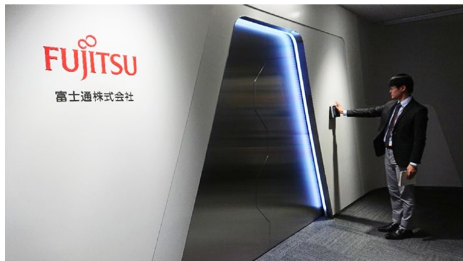
手のひら静脈認証入退室装置（富士通 Security Initiative Center）
