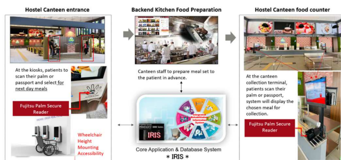
静脈認証システムを使った食堂での注文の仕組み
